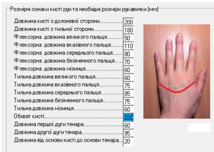
а) параметри, від яких залежать зовнішні контури деталей жіночих рукавичок
