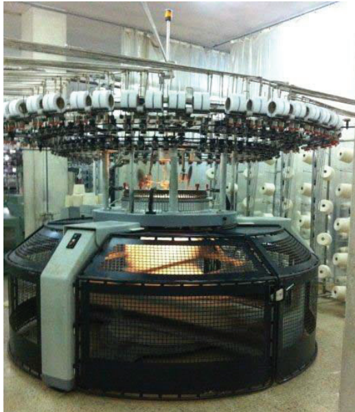
Рис.8.4.17. Форма лінії заправки ниток круглов'язальної машини Мауер
