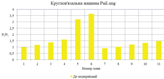
Рис.8.4.22. Діаграма зміни відносного натягу нитки у зонах заправки круглов'язальної машини PaiLung
