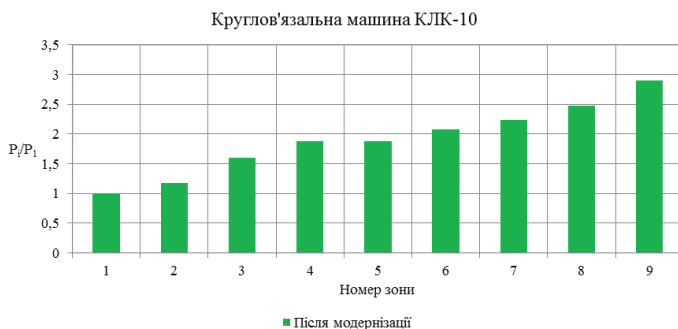
Рис.8.4.16. Діаграма зміни відносного натягу нитки у зонах заправки круглов'язальної машини КЛК – 10 після оптимізації форми лінії заправки
