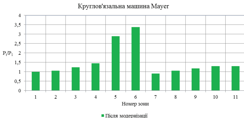
Рис.8.4.20. Діаграма зміни відносного натягу нитки у зонах заправки круглов'язальної машини Mauger після оптимізації форми лінії заправки
