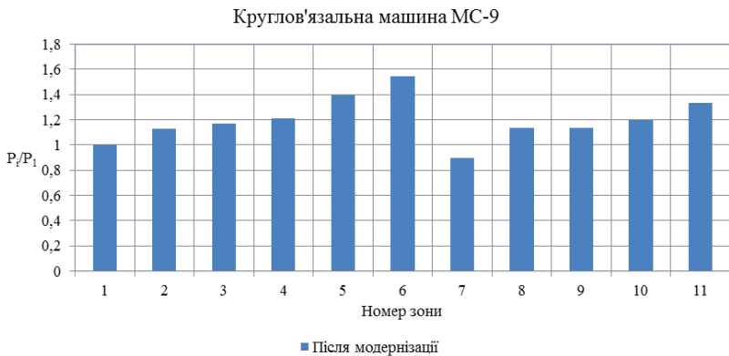
Рис.8.4.8. Діаграма зміни відносного натягу нитки у зонах заправки
