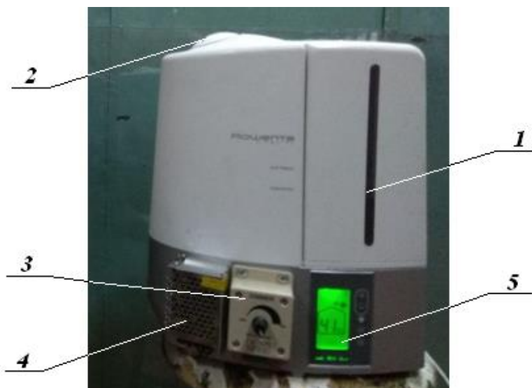
Рис. 3. Зовнішній вигляд лабораторного стенду для дослідження роботи УЗ зволожувача: 1 – резервуар; 2 – сопло; 3 – регулятор частоти обертання; 4 – блок живлення; 5 – панель керування
