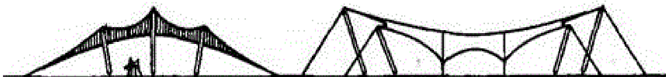
Рис. 2 Приклад тентової системи з опертям на зовнішні стійки. Проста багатоскатна поверхня на шести опорах з двома стабілізуючими вантами. [4]
