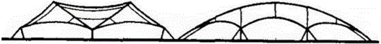
Рис. 4 Приклад тентової системи з двома арочними опорами у вигляді високої домінанти і загальними точками основи (втягнуті арочні основи). [4]
